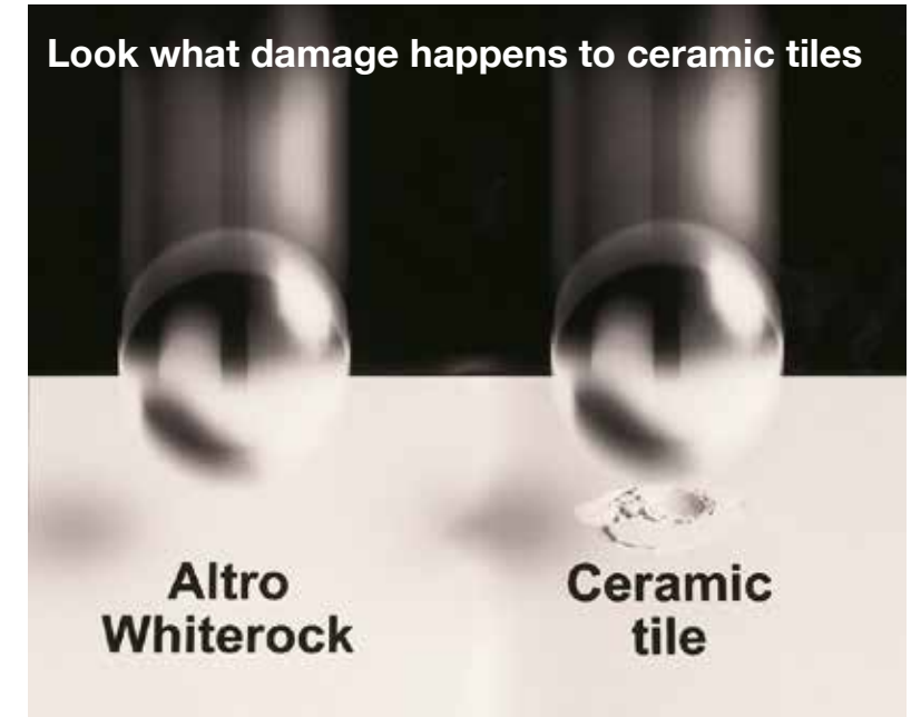
BS EN438-2-1991 Drop Ball Test
