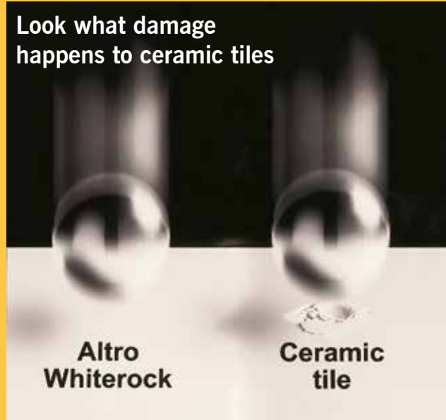
BS EN438-2-1991 Drop Ball Test
