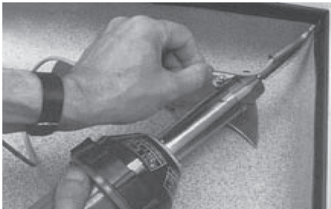
1. Acanale el inglete interno antes de soldarlo.
